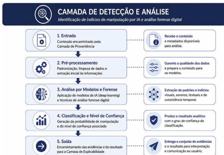
Figura 8 – Fluxo de funcionamento da Camada de Detecção e Análise.
