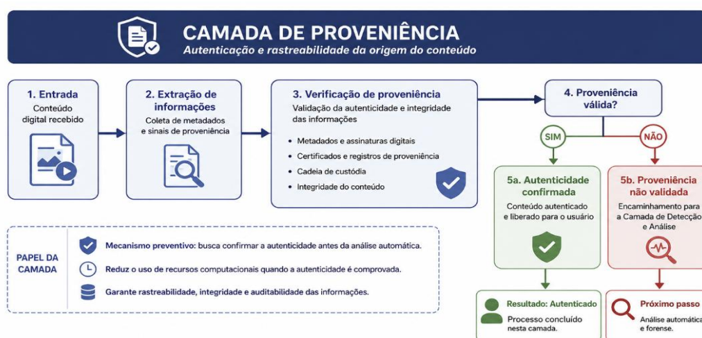
Figura 7 – Fluxo de funcionamento da camada de Proveniência.
