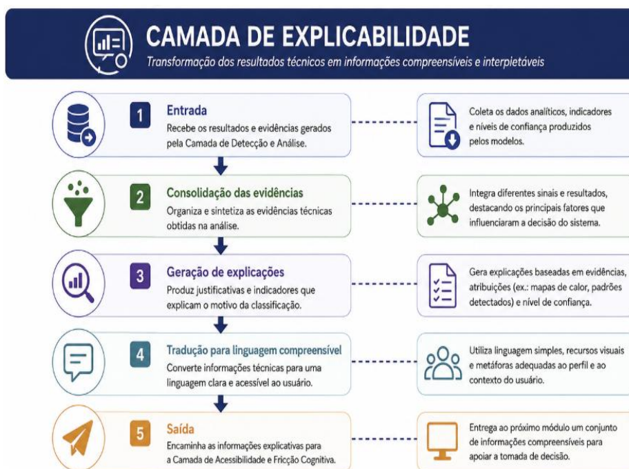
Figura 9 – Fluxo de funcionamento da Camada de Explicabilidade.
