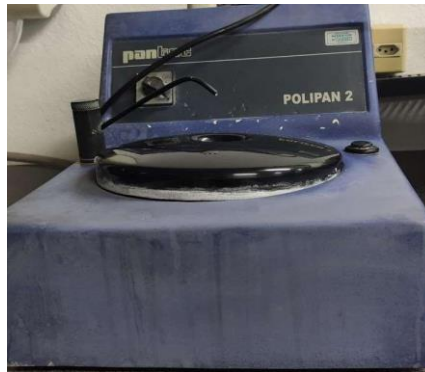
Figura 5: Lixadeira semiautomática Polipan (2).
