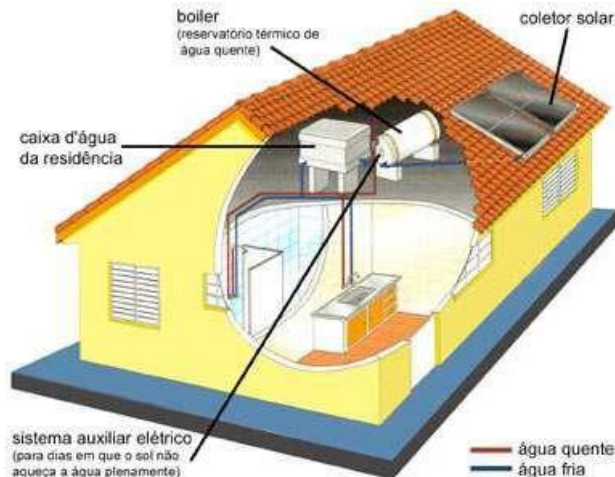
Figura 10: Sistema de energia solar para aquecimento de água. Fonte: www.naativaaquecedores.com.br
