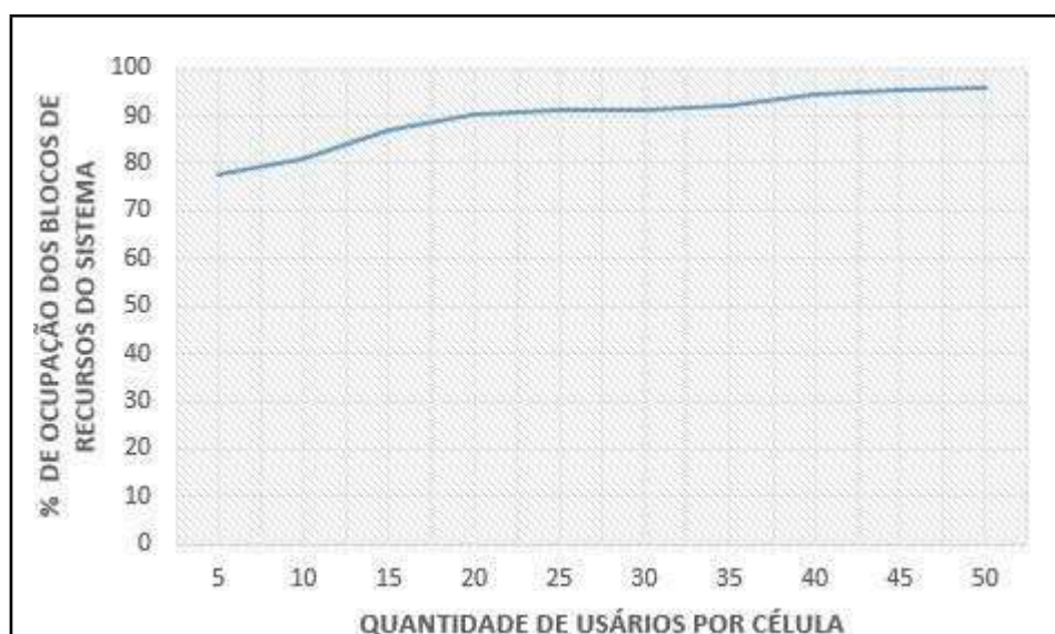
Figura 33 – Gráfico demonstrando as características de ocupação dos blocos de recurso disponíveis em um sistema com femtocélulas.
