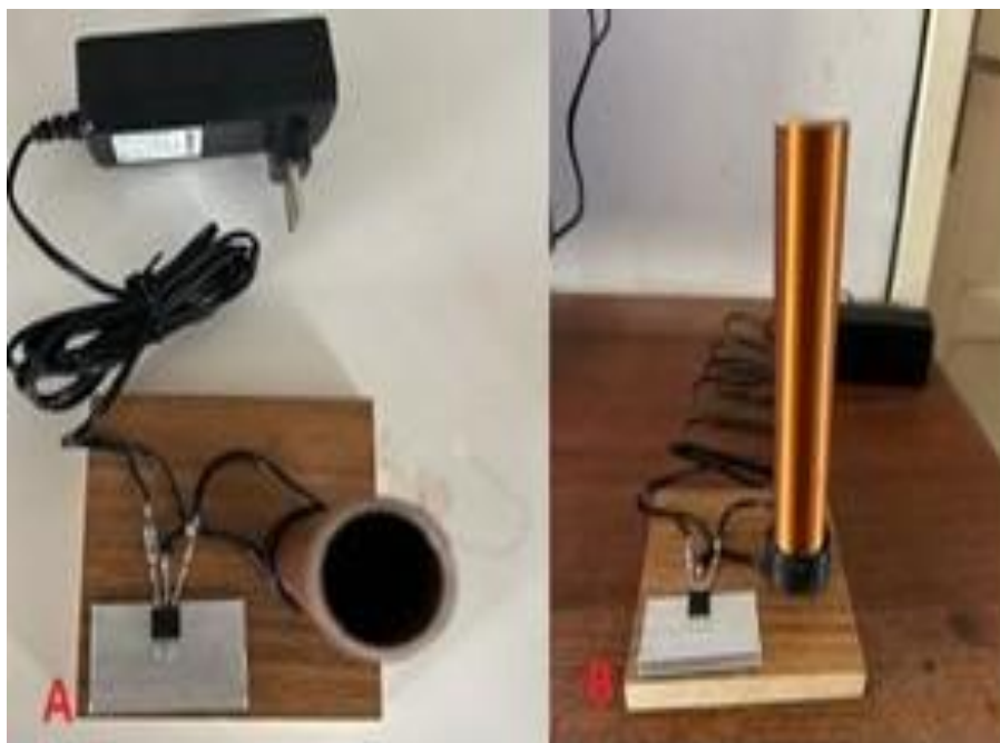
Figura 6 – Imagens da bobina de Tesla de cunho didático
