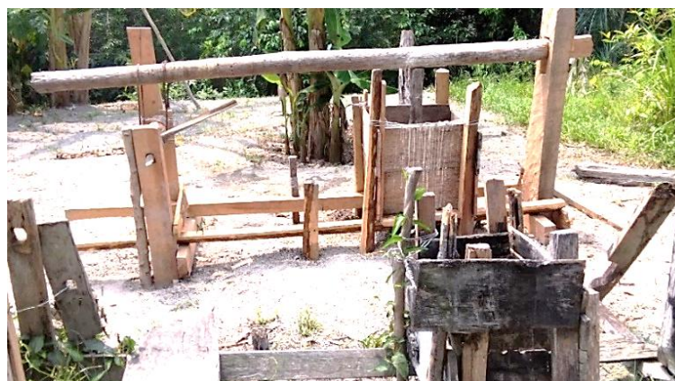
Figura 4 - Prensa para massa de mandioca
