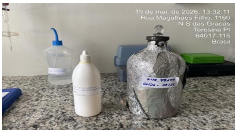
Figura 11 - Solução indicadora de Cromato de Potássio – K_2CrO_4 (frasco branco), Solução reagente de Nitrato de Prata – AgNO_3 (frasco embalado com papel alumínio)
