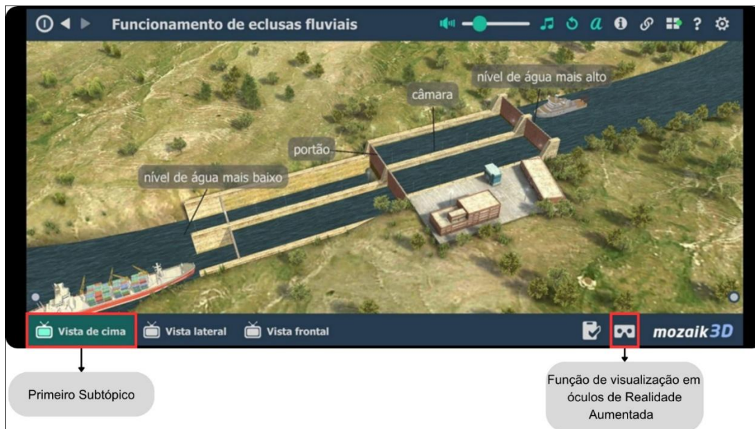
Figura 6 – Funcionamento de eclusas
