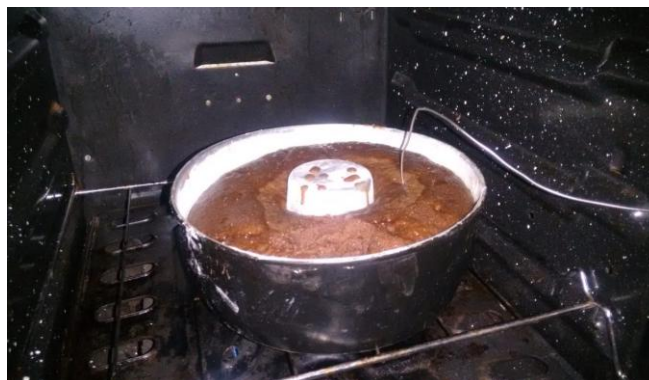
Figura 1: Foto da montagem do experimento, bolo com termômetro (termopar)
