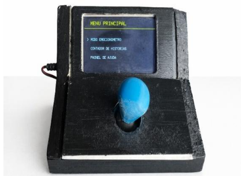
Figura 1 – Robô assistivo interativo desenvolvido para aplicação escolar.
