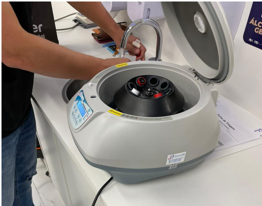
Centrífuga utilizada para produção da membrana, 10min, 2.400rpm.
