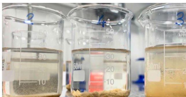
Figura 2 - Formação e sedimentação de flocos nas amostras submetidas às etapas do tratamento de efluentes.
