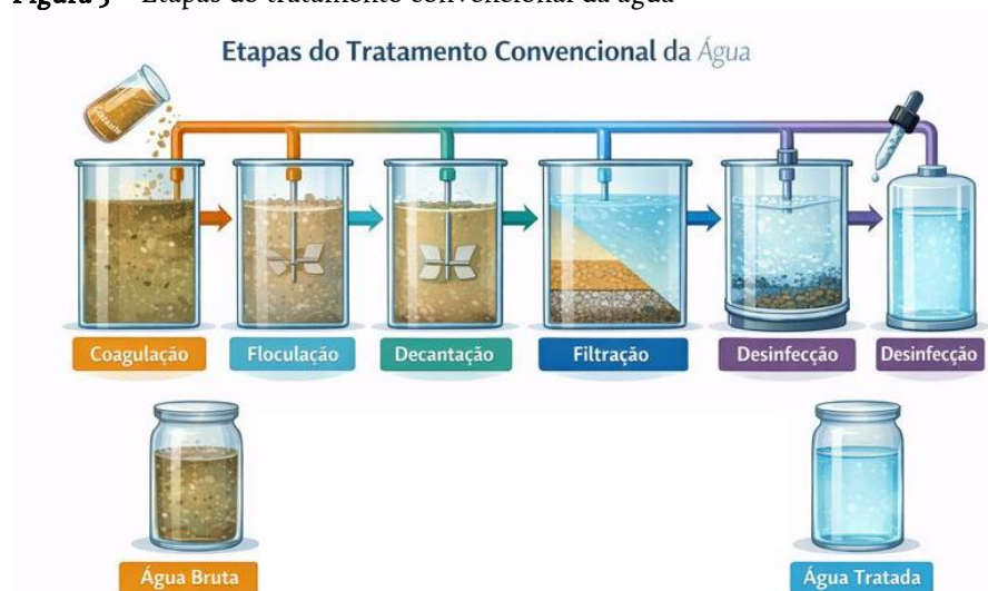
Figura 3 – Etapas do tratamento convencional da água
