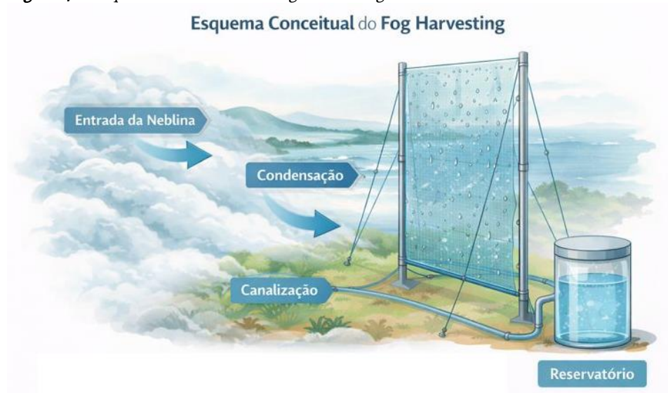
Figura 4 – Esquema conceitual do fog harvesting
