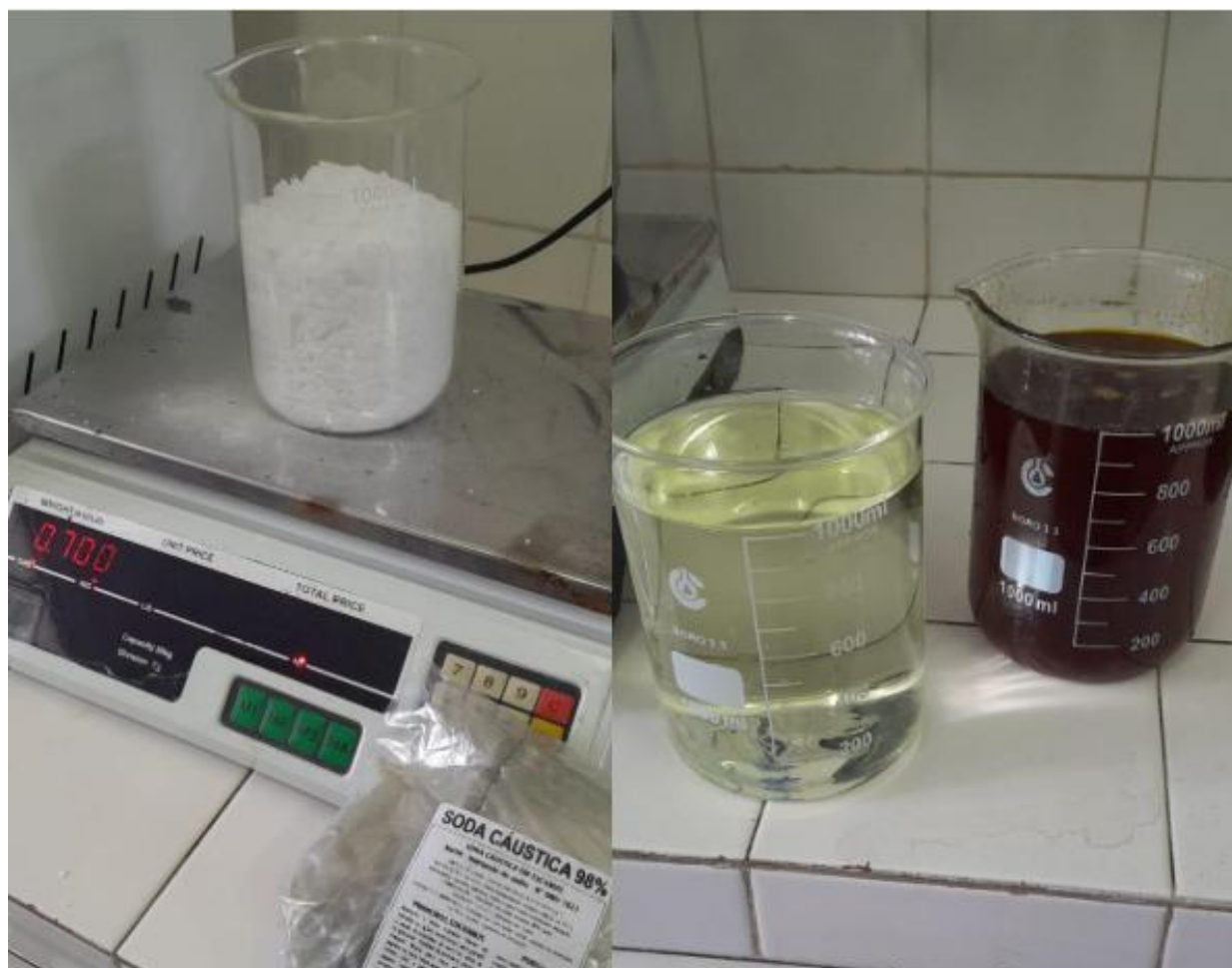
Figura 7: Pesagem da soda cáustica e medida do volume de água sanitária para tratamento do óleo.
