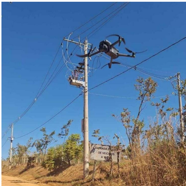
Figura 3 – Drone inspecionando rede de distribuição
