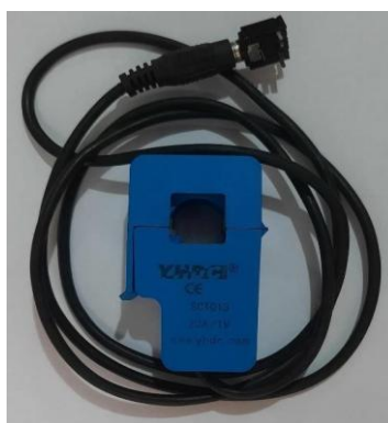
FIGURA 4: SENSOR DE CORRENTE NÃO-INVASIVO SCT-013-020
