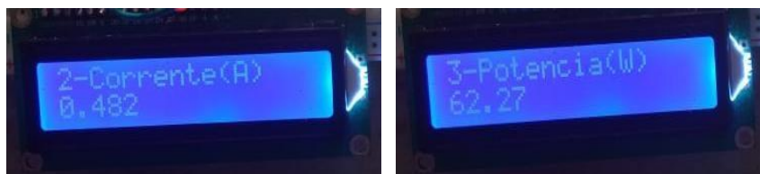
FIGURA 8: MEDIÇÃO DE LÂMPADA DE 60W
