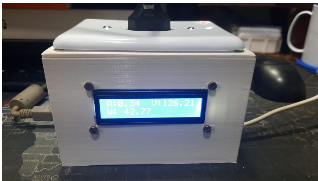
FIGURA 13: MEDIÇÃO DO FERRO DE SOLDA
