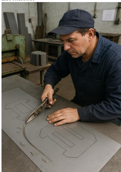
Figura 1: Processo de corte manual de chapas metálicas.
