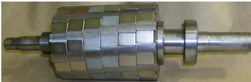
Figura 6- Rotor protótipo com ímãs inclinação intermediária - 5,0^\circ
