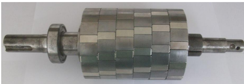
Figura 7- Rotor protótipo com ímãs inclinação intermediária - 7,0^\circ
