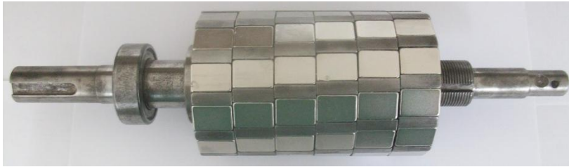
Figura 5- Rotor protótipo com ímãs inclinação intermediária - 3,7^\circ
