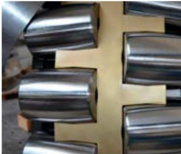
Figura 4: Rolamento após a repotencialização
