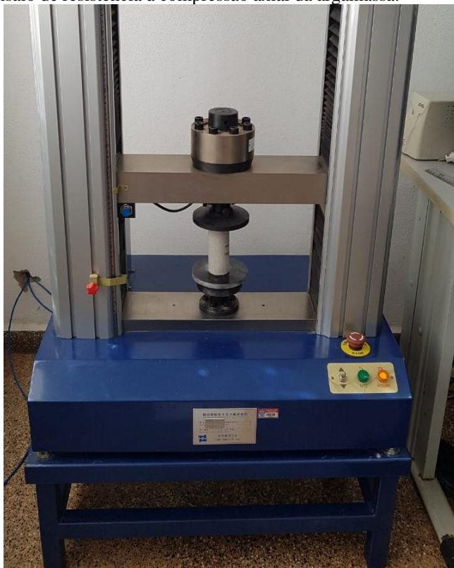
Figura 4 – Ensaio de resistência à compressão axial da argamassa.
