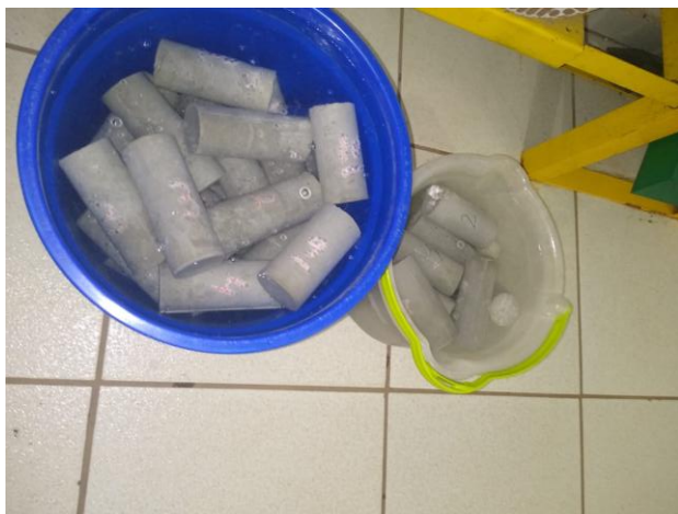
Figura 6 – Ensaio de absorção de água por imersão da argamassa.
