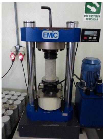
Figura 2 – Ensaio de compressão do concreto.
