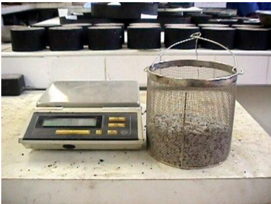
Figura 6 – Equipamentos para determinação da massa específica do agregado graúdo.
