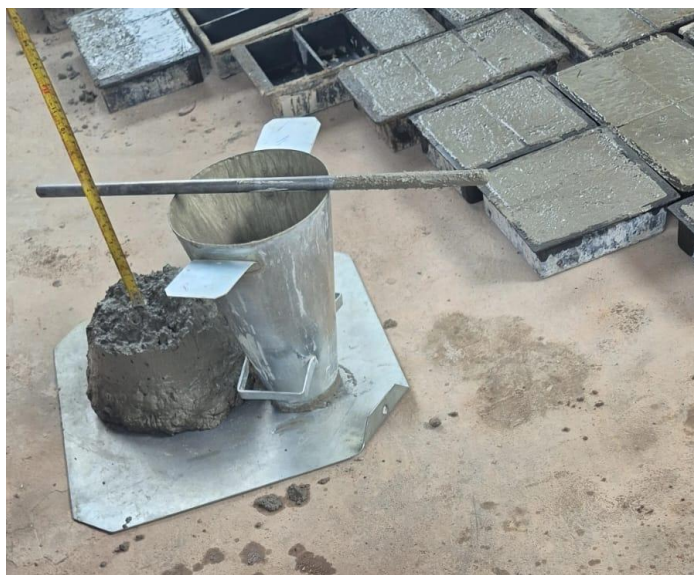
Figura 1 – Ensaio de consistência ( Slump test )
