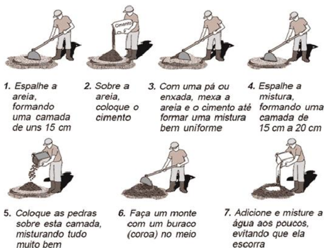
Figura 4 – Preparo manual do concreto.
