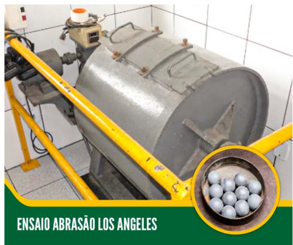
Figura 7 – Ensaio de abrasão no tambor de Los Angeles.
