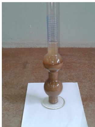
Figura 5 – Determinação da massa específica em agregado miúdo.
