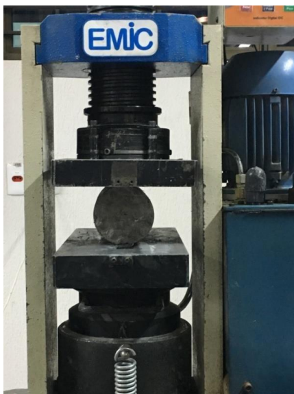
Figura 3 – Ensaio de tração por compressão diametral.
