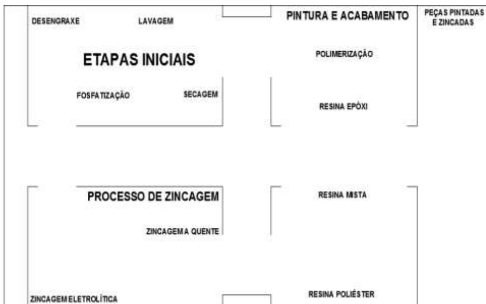
Figura 12 – Configuração do processo de tratamento superficial dos aços.
