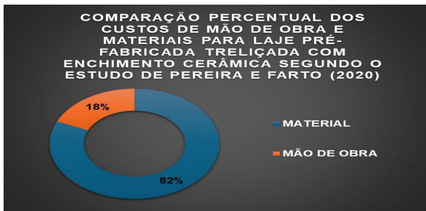
Gráfico 3 – Comparação percentual dos custos de mão de obra e materiais para laje pré-fabricada treliçada com enchimento de lajota cerâmica segundo o estudo de Pereira e Farto (2020)
