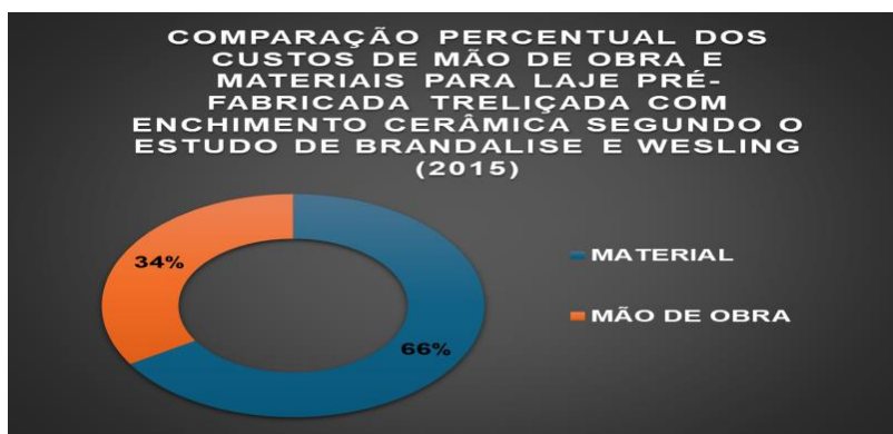
Gráfico 4 – Comparação percentual dos custos de mão de obra e materiais para laje pré-fabricada treliçada com enchimento de lajotas cerâmicas segundo o estudo de Brandalise e Wesling (2015)
