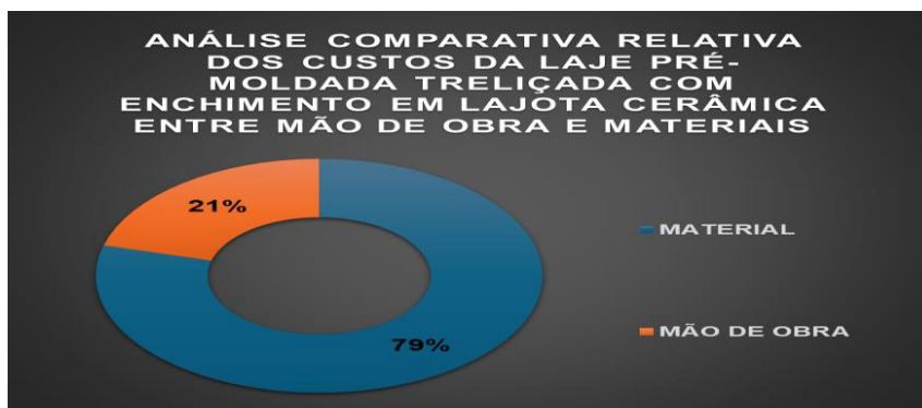
Gráfico 8 – Análise comparativa relativa dos custos da laje pré-moldada treliçada com enchimento em lajota cerâmica entre mão de obra e materiais
