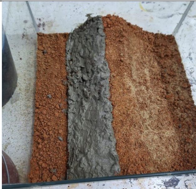
Figura 05 - Processo de construção da face de concreto.
