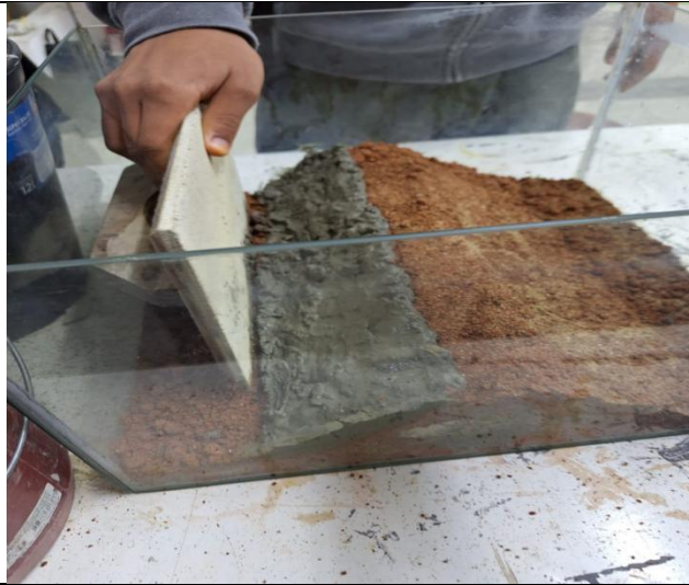
Figura 04 - Processo de preparação da face de concreto.
