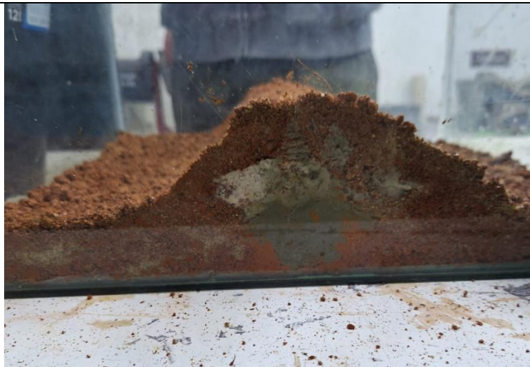
Figura 03 - Processo de preparação do Talude de enrocamento.
