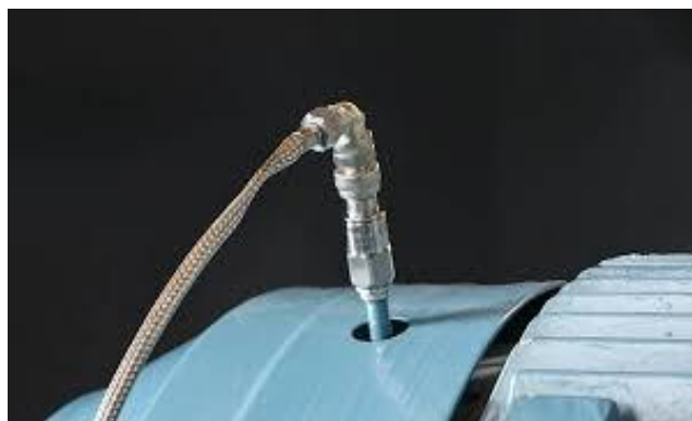
Figura 1: Sensor de vibração na prática.
